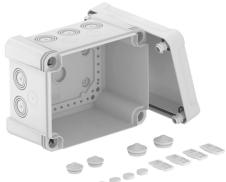
Caja de derivación para la conexión de cables y líneas en zonas interiores y zonas exteriores. Forma rectangular con entradas ciegas. Apropiado para el montaje en pared y techo con la posibilidad de fijación exterior, interior o montaje en las esquinas. Particularmente resistente a los impactos con IK09. Tapa con cierre rápido, precintable. Fabricada con materiales libres de halógenos y resistentes a los rayos UV.
