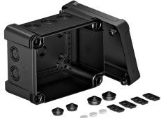
Caja de derivación para la conexión de cables y líneas en zonas interiores y zonas exteriores. Forma rectangular con entradas ciegas. Apropiado para el montaje en pared y techo con la posibilidad de fijación exterior, interior o montaje en las esquinas. Particularmente resistente a los impactos con IK09. Tapa con cierre rápido, precintable. Fabricada con materiales libres de halógenos y resistentes a los rayos UV.
