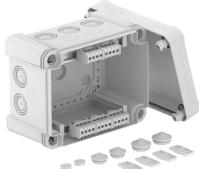
Caja de derivación con regleta de conexión para la conexión de cables y líneas en zonas interiores y zonas exteriores. Forma rectangular con entradas ciegas. Apropiado para el montaje en pared y techo con la posibilidad de fijación exterior, interior o montaje en las esquinas. Particularmente resistente a los impactos con IK09. Tapa con cierre rápido, precintable. Fabricada con materiales libres de halógenos y resistentes a los rayos UV.
