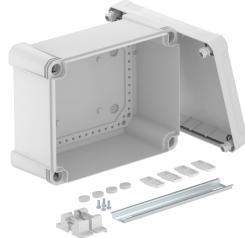
Caja de derivación con carril DIN para la conexión de cables y líneas en zonas interiores y zonas exteriores. Forma rectangular sin entradas. Apropiado para el montaje en pared y techo con la posibilidad de fijación exterior, interior o montaje en las esquinas. Particularmente resistente a los impactos con IK09. Tapa con cierre rápido, precintable. Fabricada con materiales libres de halógenos y resistentes a los rayos UV.
