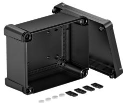
Caja de derivación para la conexión de cables y líneas en zonas interiores y zonas exteriores. Forma rectangular sin entradas. Apropiado para el montaje en pared y techo con la posibilidad de fijación exterior, interior o montaje en las esquinas. Particularmente resistente a los impactos con IK09. Tapa con cierre rápido, precintable. Fabricada con materiales libres de halógenos y resistentes a los rayos UV.
