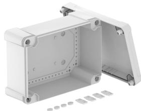
Caja de derivación para la conexión de cables y líneas en zonas interiores y zonas exteriores. Forma rectangular sin entradas. Apropiado para el montaje en pared y techo con la posibilidad de fijación exterior, interior o montaje en las esquinas. Particularmente resistente a los impactos con IK09. Tapa con cierre rápido, precintable. Fabricada con materiales libres de halógenos y resistentes a los rayos UV.
