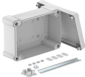
Caja de derivación con carril DIN para la conexión de cables y líneas en zonas interiores y zonas exteriores. Forma rectangular sin entradas. Apropiado para el montaje en pared y techo con la posibilidad de fijación exterior, interior o montaje en las esquinas. Particularmente resistente a los impactos con IK09. Tapa con cierre rápido, precintable. Fabricada con materiales libres de halógenos y resistentes a los rayos UV.
