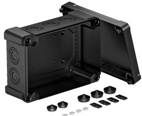
Caja de derivación para la conexión de cables y líneas en zonas interiores y zonas exteriores. Forma rectangular con entradas ciegas. Apropiado para el montaje en pared y techo con la posibilidad de fijación exterior, interior o montaje en las esquinas. Especialmente resistente a los impactos con IK09. Tapa con cierre rápido, precintable. Fabricado con materiales sin halógenos y resistente a los rayos UV.
