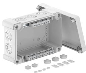
Caja de derivación con regleta de conexión para la conexión de cables y líneas en zonas interiores y zonas exteriores. Forma rectangular con entradas ciegas. Apropriado para el montaje en pared y techo con la posibilidad de fijación exterior, interior o montaje en las esquinas. Particularmente resistente a los impactos con IK09. Tapa con cierre rápido, precintable. Fabricada con materiales libres de halógenos y resistentes a los rayos UV.
