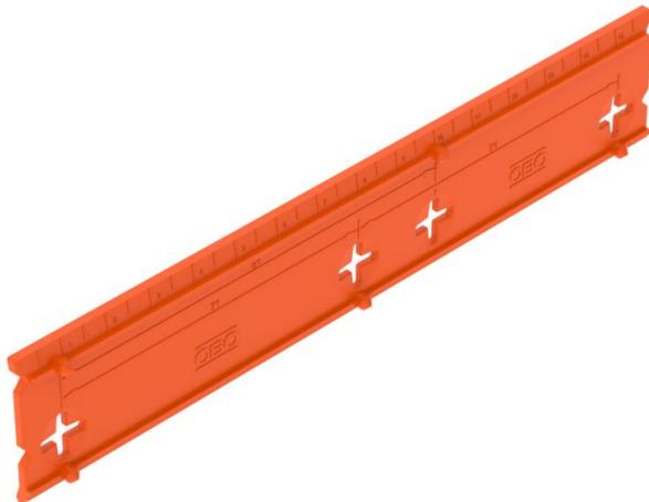
Plantilla para taladrar para cajas empotrables y para paredes huecas. Para marcar las distancias de fijación de 71 o 91 mm. Con ayudas de marcado para punzonar y con muescas para la alineación en, por ejemplo, marcas de línea de tiza.
