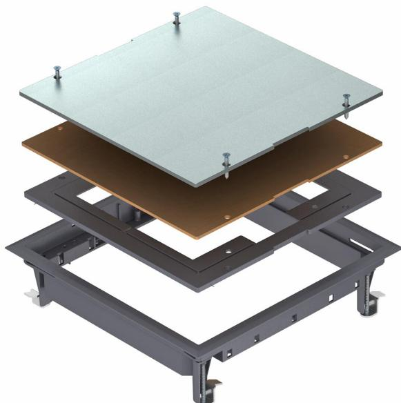
Elemento de caja de tracción para el cierre ciego de una abertura de montaje cuadrada de tamaño nominal 9 en sistemas de canalización, así como en suelos dobles y huecos en interiores. Marco protector de moqueta de poliamida. En el momento de la entrega, la entalladura para el revestimiento del suelo está ajustada a 5 mm, pero si es necesario también se puede ajustar a 3, 8 o 10 mm.
