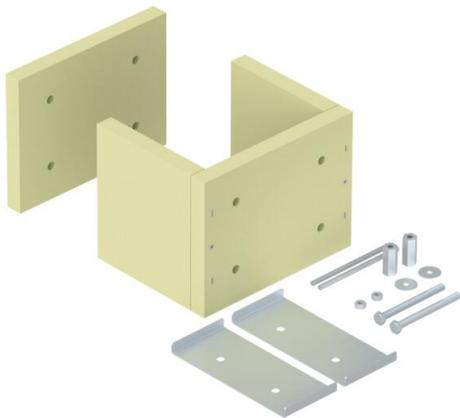
Descarga de tracción como medida de apoyo efectiva para la instalación vertical de cables según DIN 4102, parte 12. Homologado para todo tipo de cables y bandejas de escalera que se fabrican como montaje en suspensión. Clases de mantenimiento de función de E30 a E90. Carcasa vacía para el relleno individual con los sistemas aislantes de espuma de protección contra incendios PYRO-SIT® NG y/o PYROPLUG® Block, incl. juego de montaje y placa de identificación.
