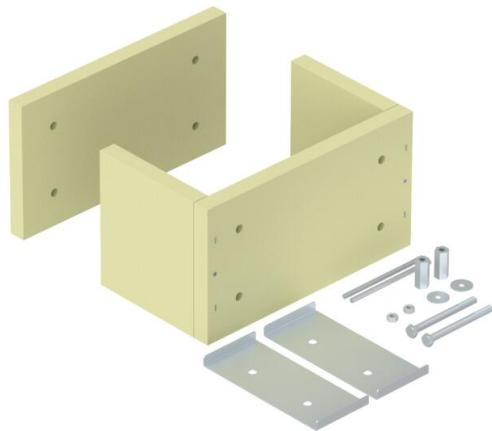
Descarga de tracción como medida de apoyo efectiva para la instalación vertical de cables según DIN 4102, parte 12. Homologado para todo tipo de cables y bandejas de escalera que se fabrican como montaje en suspensión. Clases de mantenimiento de función de E30 a E90. Carcasa vacía para el relleno individual con los sistemas aislantes de espuma de protección contra incendios PYRO-SIT® NG y/o PYROPLUG® Block, incl. juego de montaje y placa de identificación.
