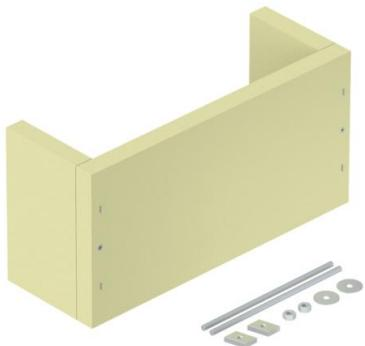
Descarga de tracción como medida de apoyo efectiva para la instalación vertical de cables según DIN 4102, parte 12. Homologado para todos los tipos de cables y sistemas de tendido que se montan directamente en paredes macizas. Clases de mantenimiento de función de E30 a E90. Carcasa vacía para el relleno individual con los sistemas aislantes de espuma de protección contra incendios PY-ROSIT® NG y/o PYROPLUG® Block, incl. juego de montaje y placa de identificación.
