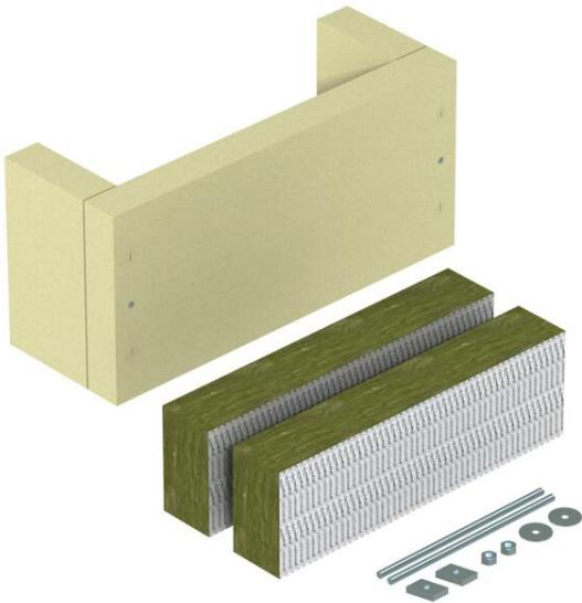
Descarga de tracción como medida de apoyo efectiva para la instalación vertical de cables según DIN 4102, parte 12, compatible con todos los tipos de cable y todos los sistemas de instalación vertical. Clases de mantenimiento de función de E30 a E90. Carcasa con placas de fibra mineral, material de fijación y cartuchos con revestimiento de protección contra incendios ASX y cuadro de caracterización.
