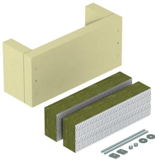
Descarga de tracción como medida de apoyo efectiva para la instalación vertical de cables según DIN 4102, parte 12, compatible con todos los tipos de cable y todos los sistemas de instalación vertical. Clases de mantenimiento de función de E30 a E90. Carcasa con placas de fibra mineral, material de fijación y caruchos con revestimiento de protección contra incendios ASX y cuadro de caracterización.
