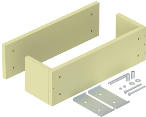
Descarga de tracción como medida de apoyo efectiva para la instalación vertical de cables según DIN 4102, parte 12. Homologado para todo tipo de cables y bandejas de escalera que se fabrican como montaje en suspensión. Clases de mantenimiento de función de E30 a E90. Carcasa vacía para el relleno individual con los sistemas aislantes de espuma de protección contra incendios PYRO-SIT® NG y/o PYROPLUG® Block, incl. juego de montaje y placa de identificación.
