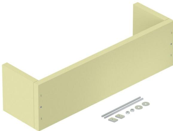
Descarga de tracción como medida de apoyo efectiva para la instalación vertical de cables según DIN 4102, parte 12. Homologado para todos los tipos de cables y sistemas de tendido que se montan directamente en paredes macizas. Clases de mantenimiento de función de E30 a E90. Carcasa vacía para el relleno individual con los sistemas aislantes de espuma de protección contra incendios PY-ROSIT® NG y/o PYROPLUG® Block, incl. juego de montaje y placa de identificación.
