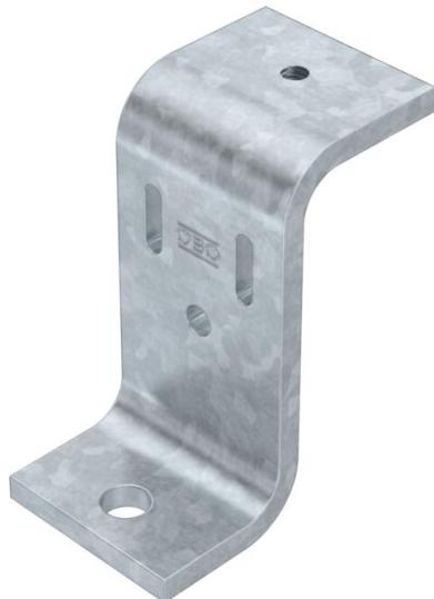
El apoyo en Z sirve para el montaje del sistema de bandejas portacables transitables BKRS en la base. Fijación de la bandeja portacables al soporte Z con tornillo de cabeza plana FKS 6 x 12 mm (ref. 6049246) en orificio roscado M6
